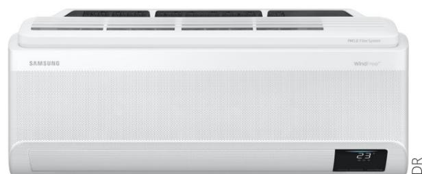
Le WindFree Pure est doté de la fonctionnalité Freeze Wash qui permet de nettoyer l'unité et de supprimer jusqu'à 90 % de certains types de bactéries. Lors de son activation, l'échangeur thermique de l'unité intérieure est refroidi à -15°C de manière à être recouvert de givre. Lorsque le mode dégivrage est activé, la glace fondue supprime certains types de bactéries dans l'échangeur thermique.
